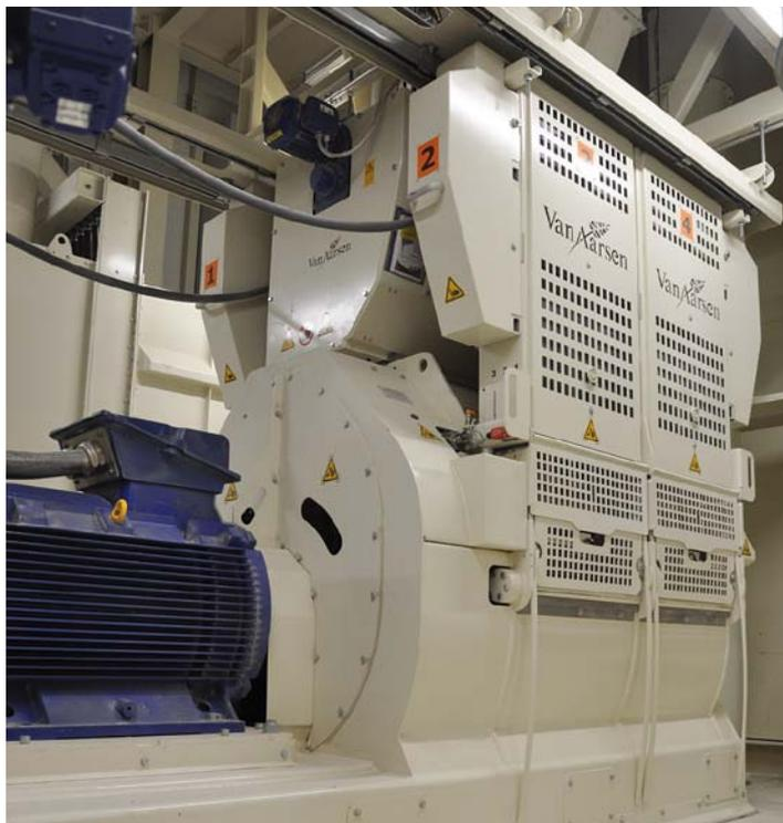
GD-Hammermühle mit automatischem Siebwechsel
